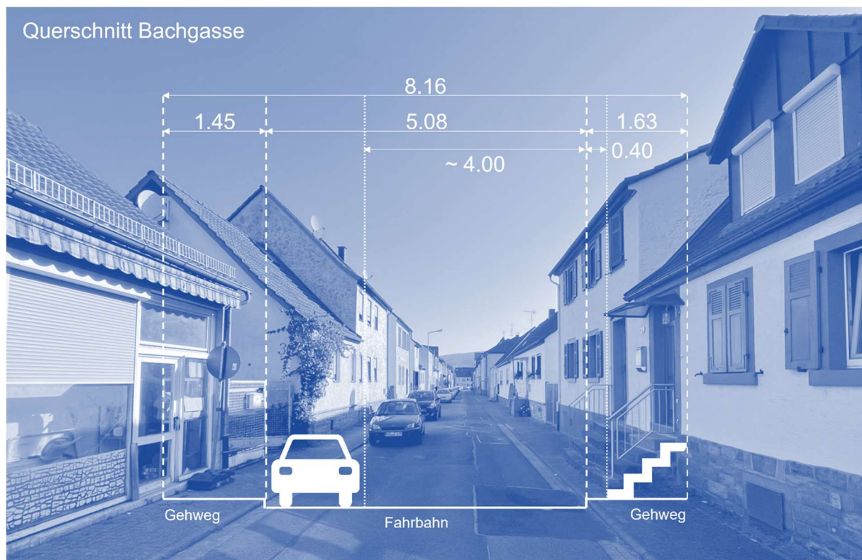
Abbildung 3: Beispielhafter Querschnitt der Bachgasse
